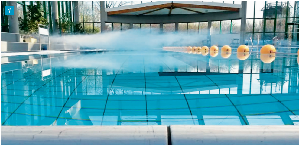
1 | Nebelversuch: Typische horizontale Schichtung über der Beckenwasseroberfläche
